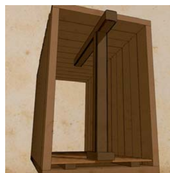
Dessin schématique du mode de construction du Kilianstollen (images S. Soussoko ; données PAIR)
